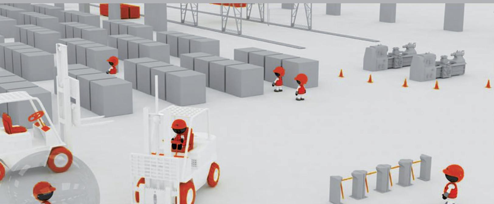
Il sistema Zoning+ è uno strumento a tutela della sicurezza che garantisce il controllo degli accessi monitorando il personale e i mezzi in specifiche aree operative. Il risultato è un costante aggiornamento dello stato delle presenze di operatori e mezzi all'interno di ogni specifica area.
